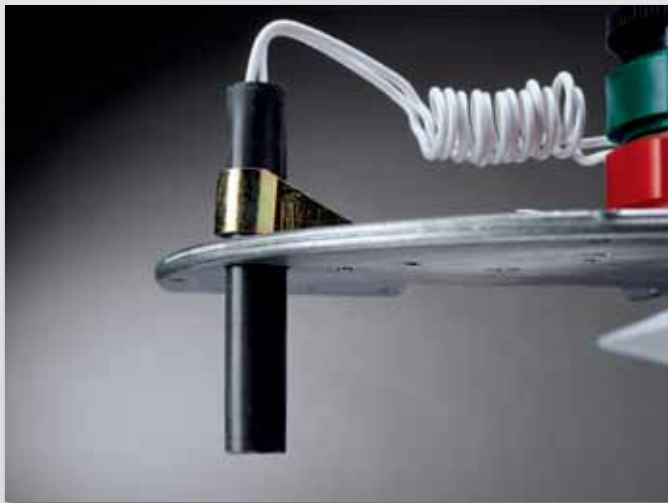
CALENTADOR: Se puede agregar un calentador autorregulable para evitar un posible daño a los componentes eléctricos a causa de la acumulación de condensación dentro del actuador. Montados en la placa superior del actuador para permitir una fácil accesibilidad.
