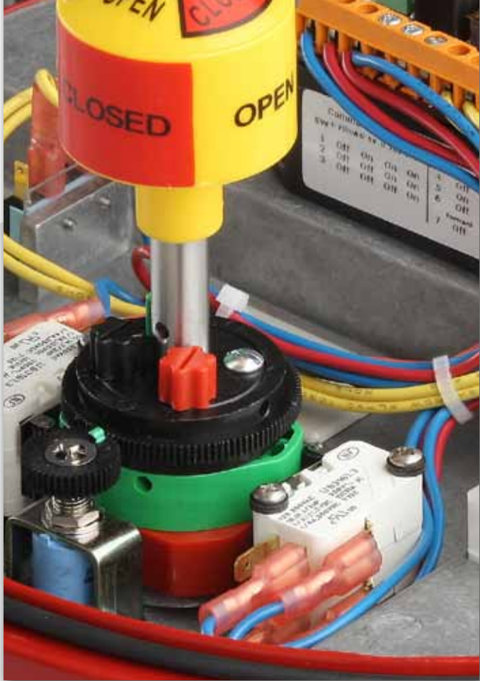
INTERRUPTORES AUXILIARES: Los interruptores mecánicos independientes de contacto seco de SPDT sirven para indicar la posición de desplazamiento a los sistemas remotos de control que posee el cliente.
